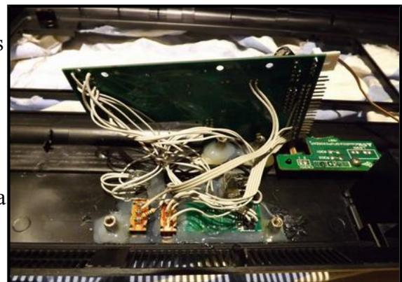
Aquí ya puedes ver como queda la placa atornillada al chasis. Puedes observar que no se ve ni un solo hilo. Y lo mejor de todo es que solo tenemos dos conectores extraíbles que nos comunicarán la placa USB con la placa del ordenador. Al fondo, se puede observar el cable del led de encendido. Ese será el tercer y último cable que conectará el frontal con la placa, pero este ya estaba ahí.
